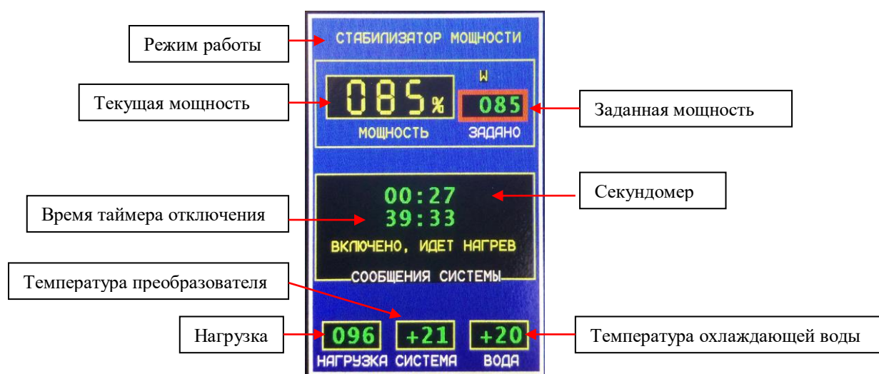
Рисунок 5. Вид дисплея в режиме стабилизации мощности при нагреве тигля.
