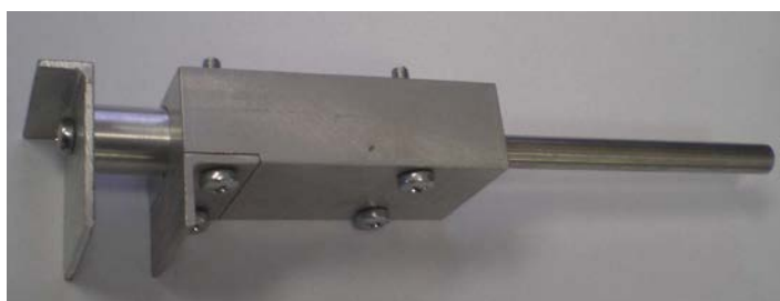
Рисунок 2 – Механизм подъема штока
