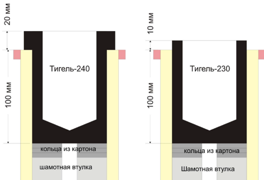
Рисунок 5 Правильное размещение тиглей во вставке ТВ240В
